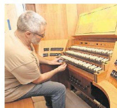
Orgelbauer Christhard Grummt (59) misst den Tastendruck am Orgelpult.
